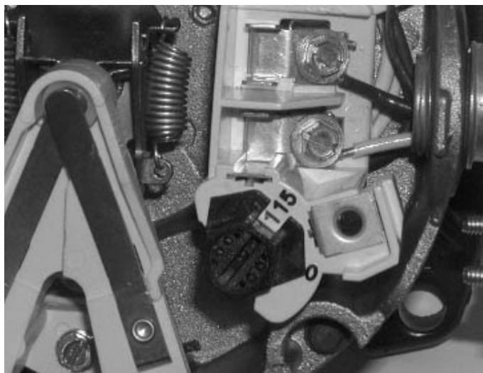
Figura 4: Motor configurado para funcionar a 115 V
