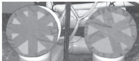
Figura 9 Carcasas de chorro cubiertas
