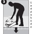
Coloque el limpiador en la piscina. Suelte el limpiador de piscina y deje que se sumerja en el fondo de la piscina. Asegúrese de que el cable flotante no está obstruido.
