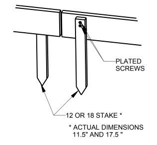
3b USE A STEEL"J" STAKE LEAVING A GAP FOR THERMAL EXPANSION
